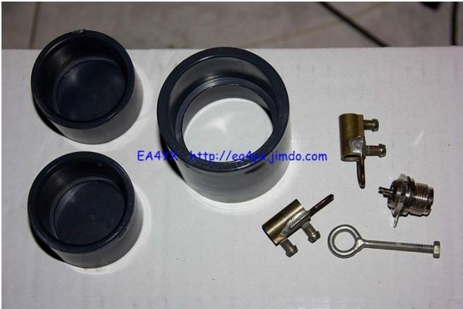
El cable coaxial solo se corta la malla que es la que hay que soldar una al vivo del conector PL Hembra y otro a la masa de dicho conector, el vivo del cable coaxial no se corta.
